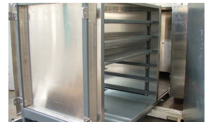
Labortrockner 2: Trocknerwagen für Pralltrockner Laboratory dryer 2: Dryer car for impact dryer
